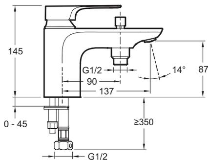
Спецификация продукта: Моноблочный однорычажный смеситель для ванны/душа. E72321. Коллекция: ALEO+. ВЕС: 1,8 кг. ТИП УСТАНОВКИ: 1 отверстие. ТИП: Однорычажный. РАСХОД ВОДЫ: 26 л/мин. ВЫСОТА ПОД ИЗЛИВОМ: 145 мм. РАССТОЯНИЕ МЕЖДУ ЦЕНТРОМ ИЗЛИВА И ЦЕНТРАЛЬНОЙ ОСЬЮ КОРПУСА: 137 мм. МЕХАНИЗМ: Керамический картридж. СЛИВ: 0. МОДЕЛЬ СМЕСИТЕЛЯ ДЛЯ КУХНИ: Механика. ОДНОРЫЧАЖНЫЙ СМЕСИТЕЛЬ: МЕХАНИКА. УСТАНОВКА: 1 отверстие. ГАРАНТИЯ НА ОТДЕЛКУ: 10 лет.
